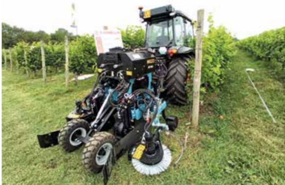
La gamma Spedo spazia da attrezzature estremamente complesse fino a trinciatrici convenzionali che si distinguono per affidabilità e durata nel tempo. La Polaris DE 14 serie Nettuno opera in interfilare minimo di 190 cm ed effettua la lavorazione del terreno, il taglio dell'erba e la spollonatura della vite in modo completamente meccanico senza danneggiare la pianta
