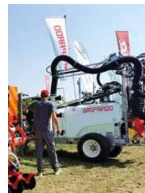
Maschio Gaspardo ha puntato molto sui trattamenti fitosanitari con una gamma completa di attrezzature portate e trainate. In particolare quelle dotate di ventola con tecnologia Avant TGZ pensate per una distribuzione ottimizzata senza effetto deriva grazie ad un'accurata nebulizzazione del prodotto
